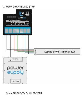
LED STRIP max 4A LED STRIP max 4A LED STRIP max 4A LED STRIP max 4A
